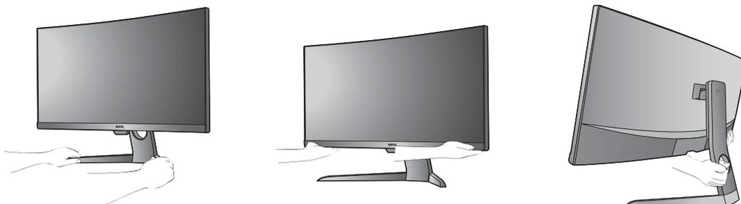
Ein Druck mit den Fingern auf die Oberfläche des Bildschirms ist nicht erlaubt. Der Bildschirm könnte durch zu großen Druck beschädigt werden.
